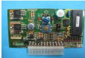
**Steuerplatine für Pumpen mit Endschalter**
