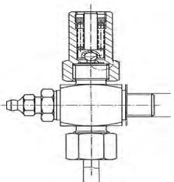
Überdruckventil 90c 300 Bar
