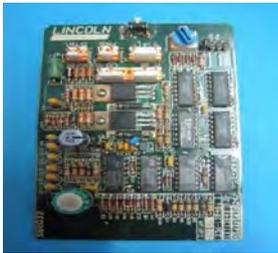
**Steuerplatine Lincoln elektrische Fließfettpumpe**
