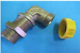
Pumpenbefüllanschluß für Befüllpumpe
