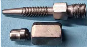
Stutzen für Hd Schlauch mit Ü-Wurf u. Schneidring
